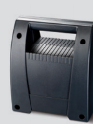
Akku-Pack Nennspannung 12 V DC, Nennkapazität 15 Ah, Nutzungsdauer 40 Tage bei max. 4 Öffnungen pro Tag und bei einer Temperatur von 20 °C, Temperaturbereich - 15 ° bis + 45 °C, integrierter Laderegler für Steckernetzteil • Geeignet für: Novomatic 423 Accu
