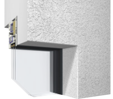
Laibungsvariante mit verdeckt liegenden Fensterrahmen
